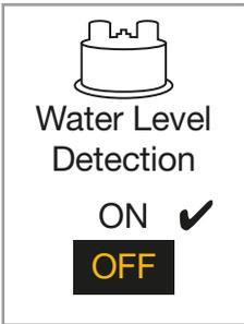
Der aktive Befeuchter AIRcon erkennt den Wasserfüllstand in der Befeuchterkammer selbstständig. Sollte der Wasserstand in der Befeuchterkammer die maximale bzw. minimale Füllstandshöhe über- oder unterschreiten, wird eine akustische und optische Alarmmeldung ausgelöst. Die wählbaren Optionen der automatischen Wasserfüllstandserkennung bedeuten:
