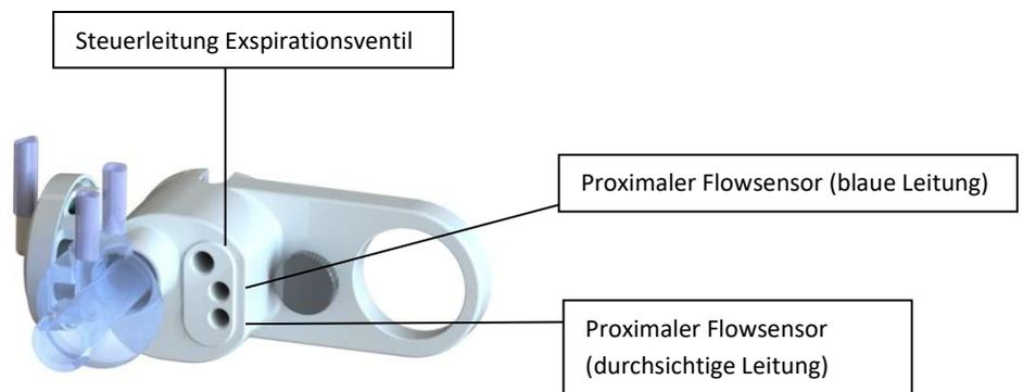
Abbildung: Adapter für zweischenkliges System
