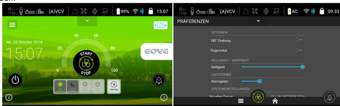
Die Schaltfläche erscheint in der Farbe des aktiven Alarms (rot oder gelb). Drücken Sie auf diese Schaltfläche, um den aktiven Alarm für zwei Minuten zu unterdrücken. In dieser Einstellung wird jeglicher neuer Alarm den Alarmton wieder auslösen.
