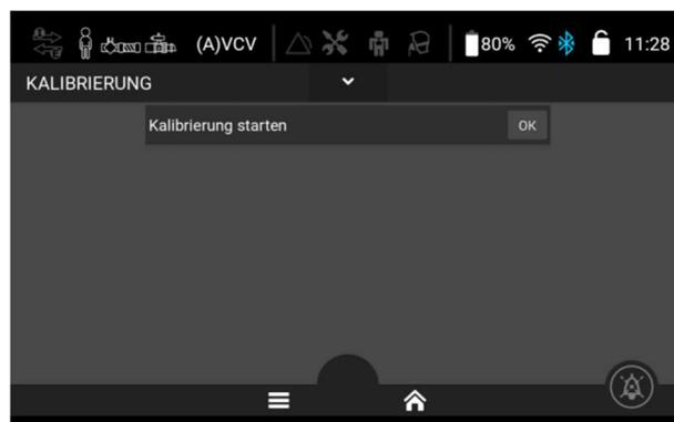
4. Setzen Sie das Schlauchsystem am Patientenanschluss auf Aufforderung dicht, entweder mit der Hand oder mit einem Stopfen.
