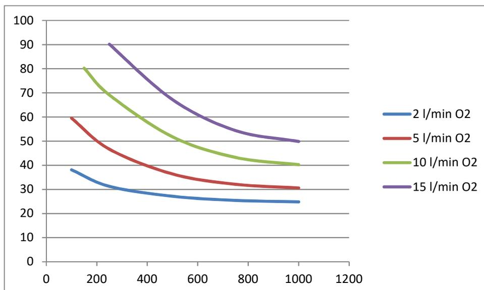
Abbildung: Theoretische Schwankung des FiO<sub>2</sub>-Prozentsatzes in Abhängigkeit vom Tidalvolumen in ml
