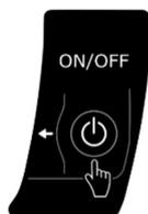
Wenn sich an der Vorderseite des Geräts dieses Symbol befindet, wird die Dockingstation beim Ein- oder Ausschalten des Ventilationsmoduls automatisch ebenfalls ein- bzw. ausgeschaltet.
