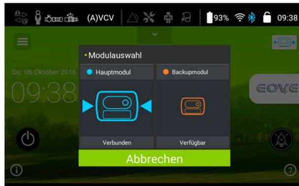
In diesem Beispiel führt die Auswahl des Backup-Moduls dazu, dass die Verbindung zum Backup-Modul wechselt. Das Gerät fragt Sie zunächst, ob Sie die Verbindung des aktuellen Moduls trennen möchten. Erst dann schaltet es auf das Backup-Modul um.
