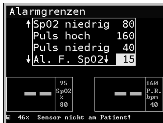
Abb. 50: Auswählen der Alarmfilterdauer
