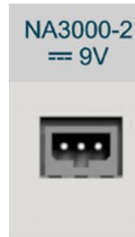
Abb. 7 Anschluss für Netzadapter
